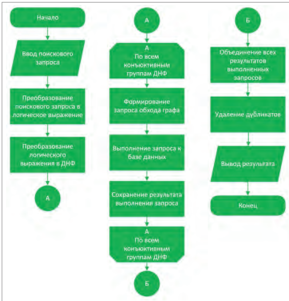
Рисунок 6 – Блок-схема обобщенного поискового алгоритма
