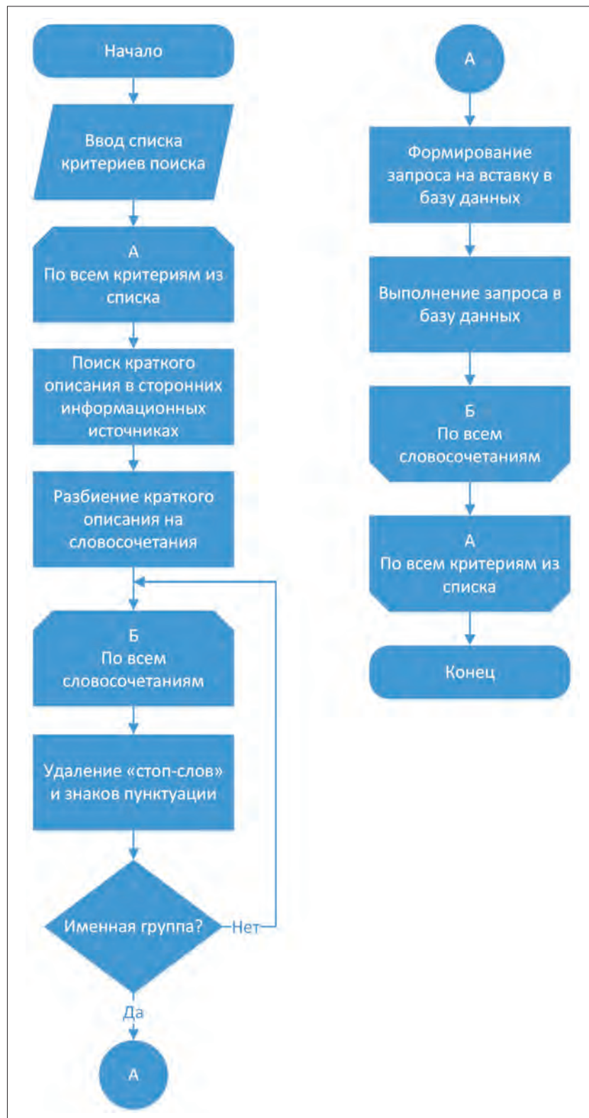
Рисунок 5 – Блок-схема алгоритма токенизации
