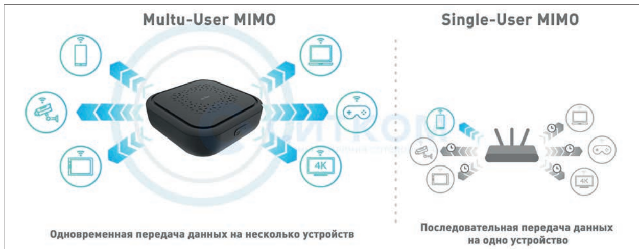
Рисунок 2 – Сравнение технологии Mu-MIMO и SU-MIMO
