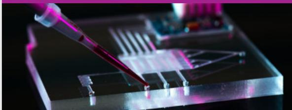
Новый гидрогель, способный формировать «строительные блоки» вроде конструктора LEGO, создан исследователями Университета Брауна (США). Новый материал идеален для создания более практичных, «мягких» роботов. Из него можно формировать кастомные микрожидкостные устройства, или «лаборатории-начипе», и применять, например, в медицине для выявления агрессивных форм рака или изготовления лекарственных препаратов.
